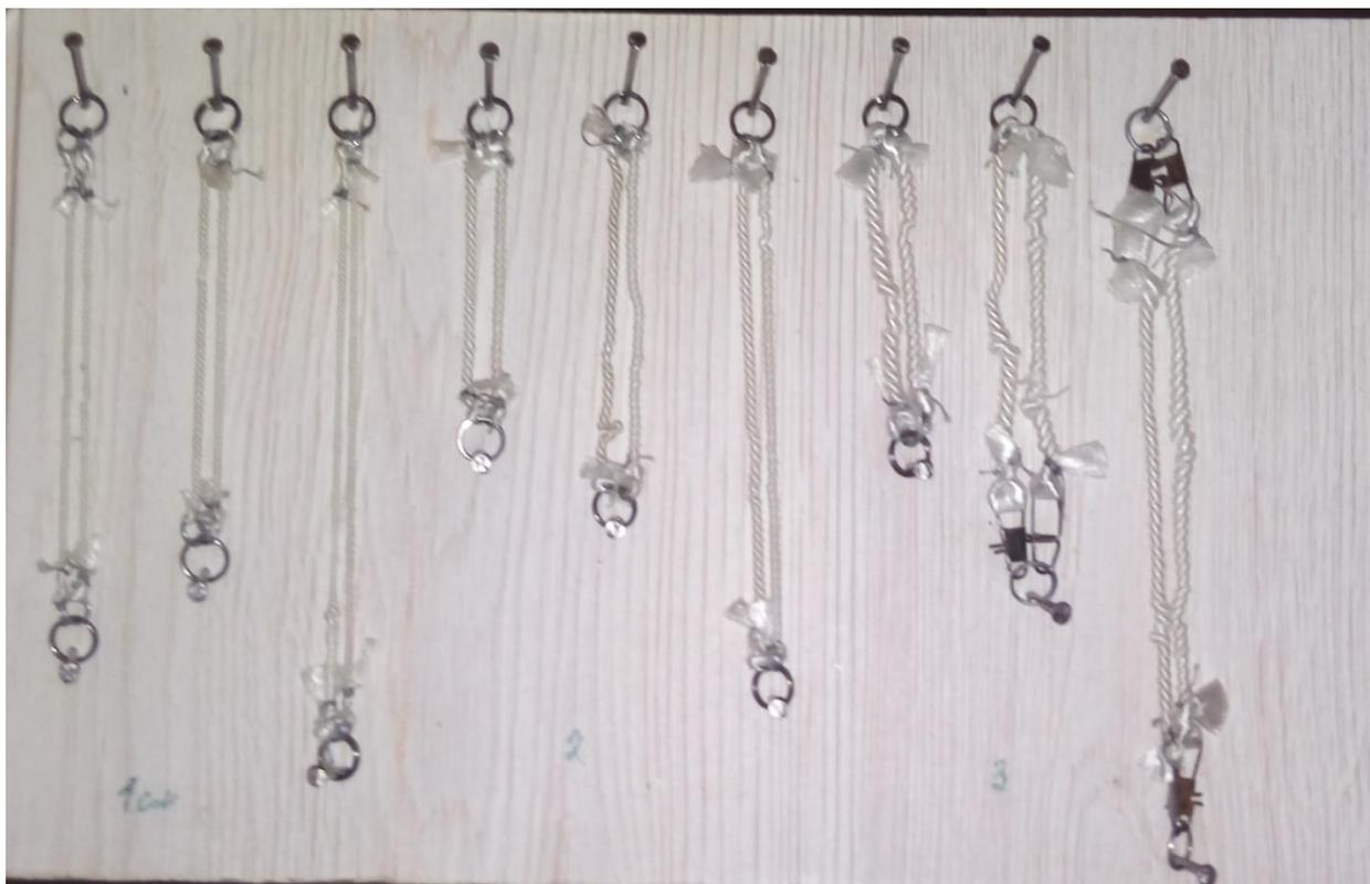
Рис. 1. Искусственные мышцы для проведения экспериментальных исследований
